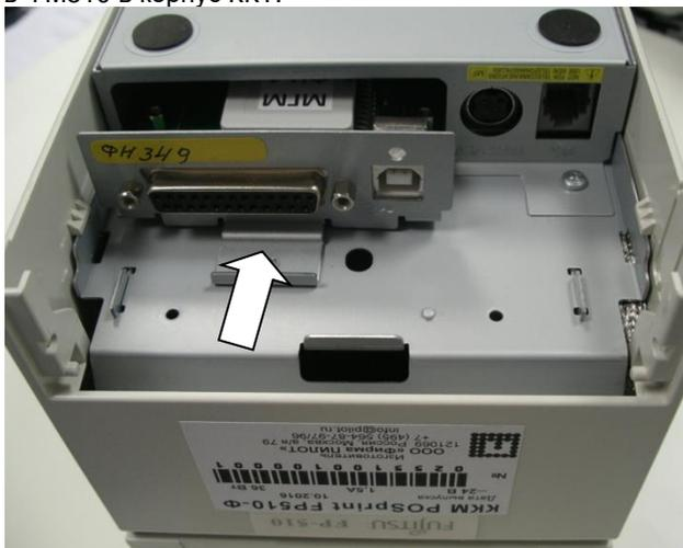
13. Закрепить планку ФМ510 на корпусе ККТ. Винт по центру планки возле разъёма DV25F должен быть по DIN 965 M=3 L=8mm (с потайной головкой).
