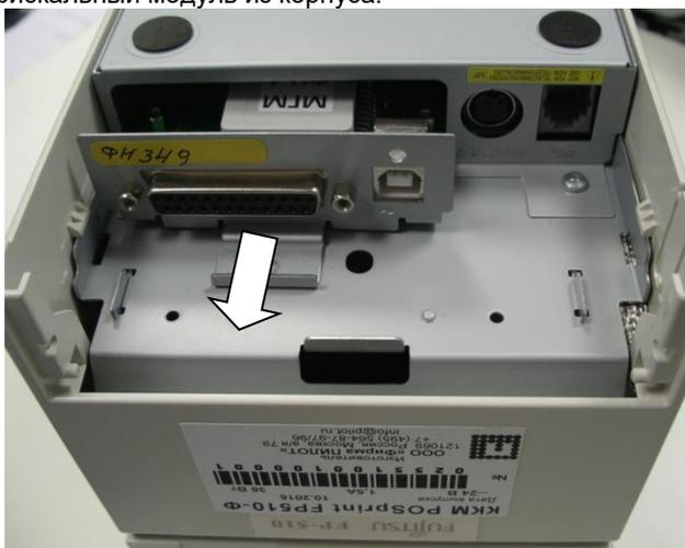
10. Снять ФН с фискального модуля ФМ510
