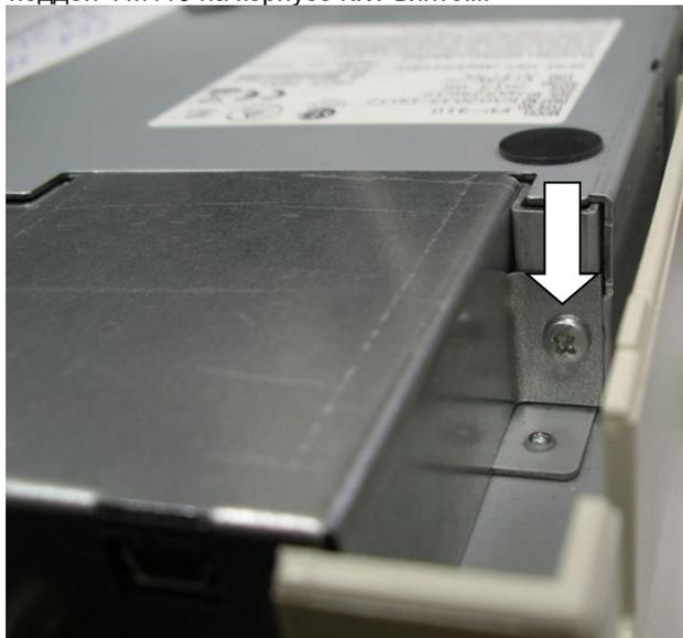
15. Установить винт с пломбировочной чашкой, установить мастичную пломбу.
