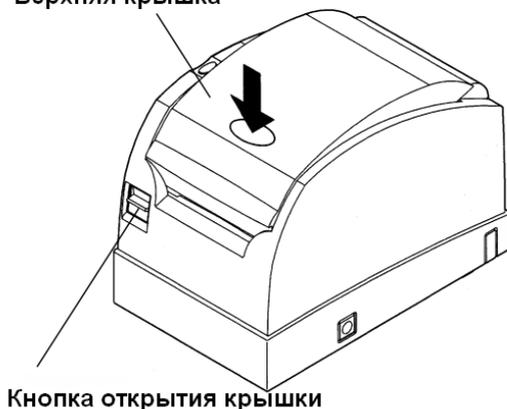
Нажать рычаг открывания верхней крышки и, подняв ее вверх, заправить бумагой, как на рисунке 7. Термоактивная сторона бумаги должна быть расположена сверху. Закрывать верхнюю крышку следует, прижимая посередине, до характерного щелчка защелки. При использовании рулона бумаги шириной 80мм пластиковая перегородка-разделитель находится в крайнем левом положении, см. рис. 8.
